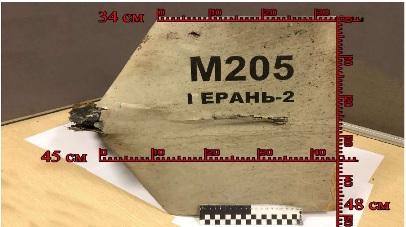
Рис. 69 фрагмент крила БПЛА "Shahed-136"
