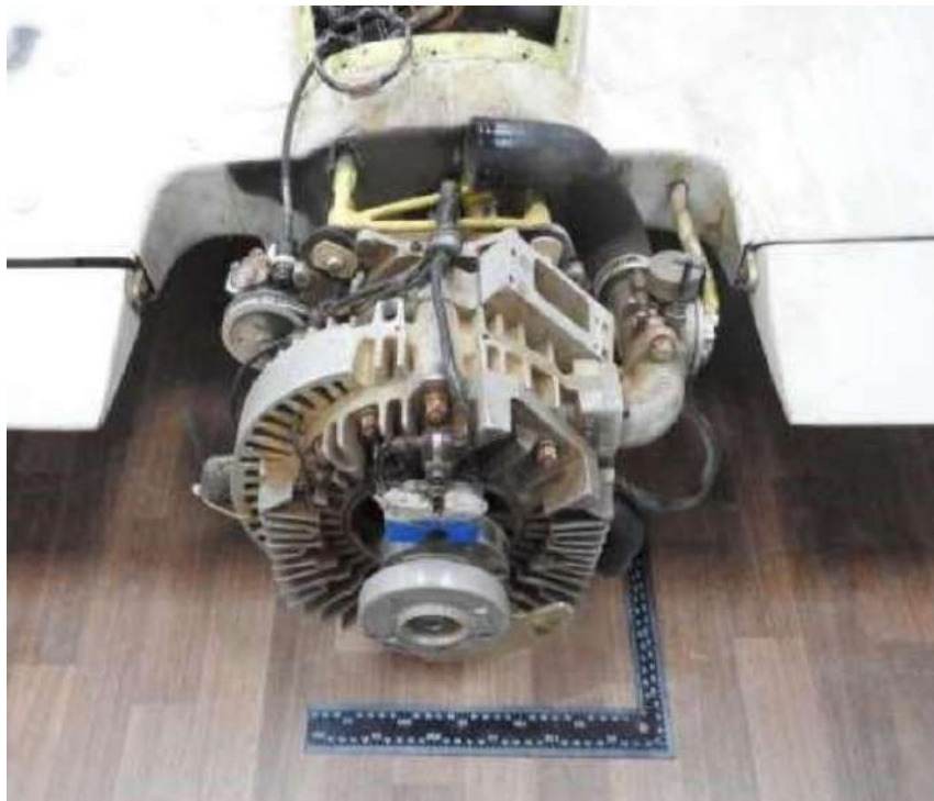
Рис. 32 Двигун внутрішнього згоряння IRN-05 Combustion Engine
