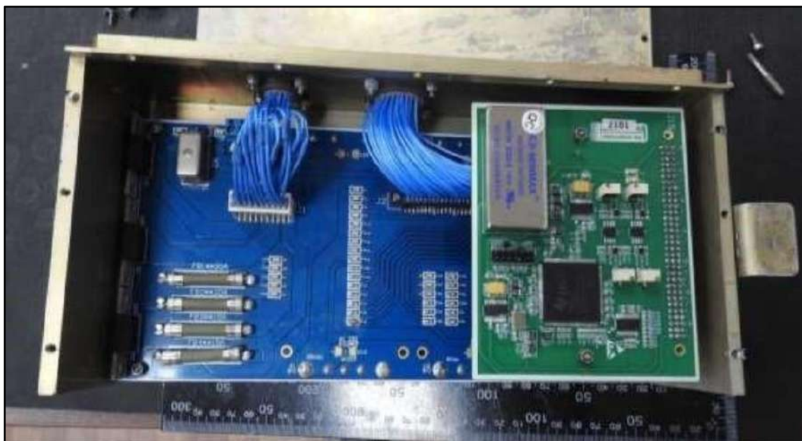
Рис. 16 Вміст Блоку розподілу живлення
