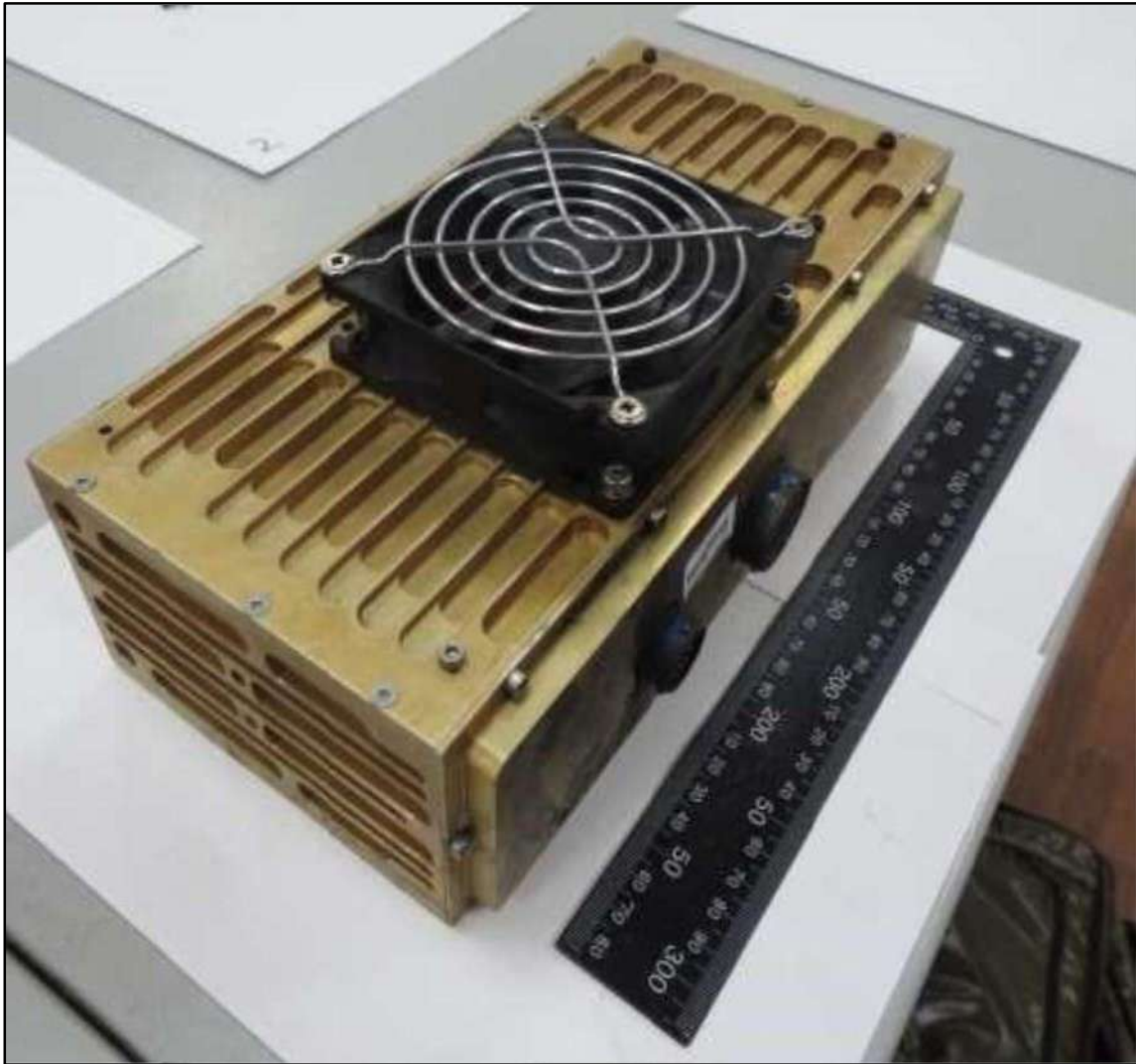
Рис. 15 Блок розподілу живлення Power Distribution Unit (PDU) БПЛА "Shahed-131" (Герань-1)
