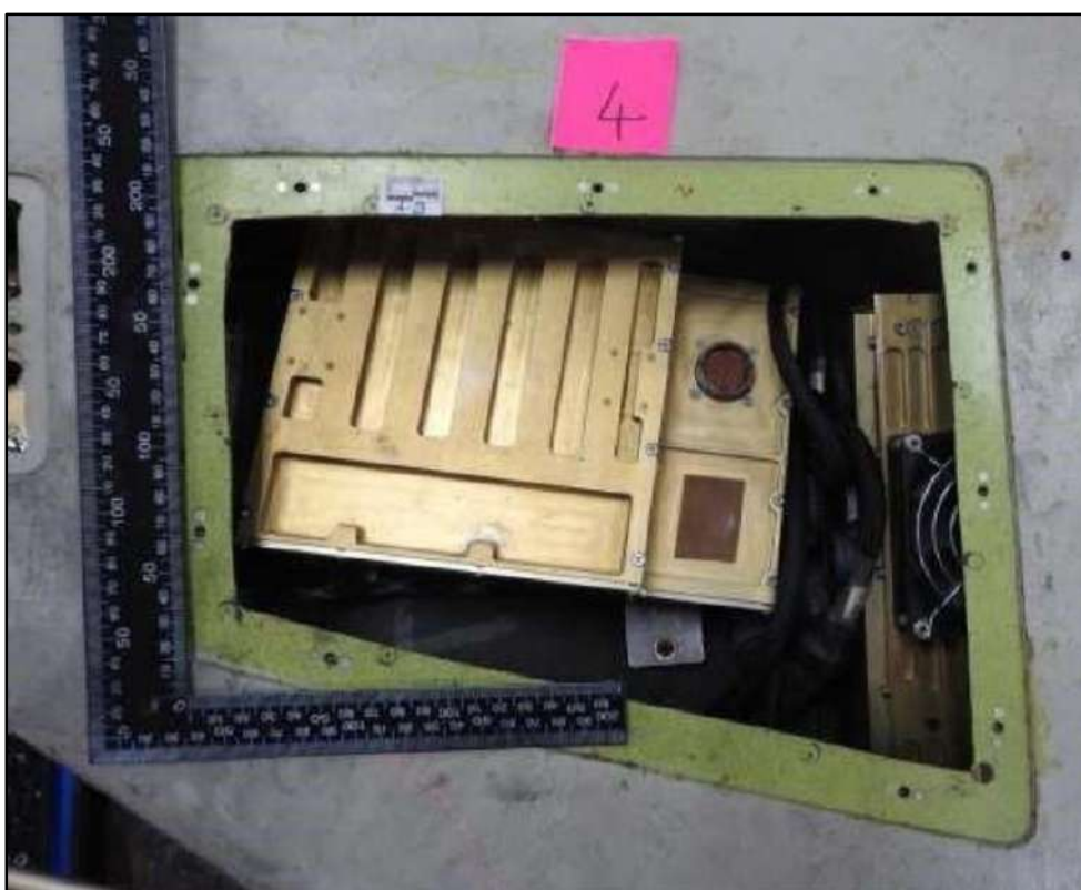
Рис. 12 Панель № 4 - Блок керування польотом FCU БпЛА "Shahed-131" (Герань-1)
