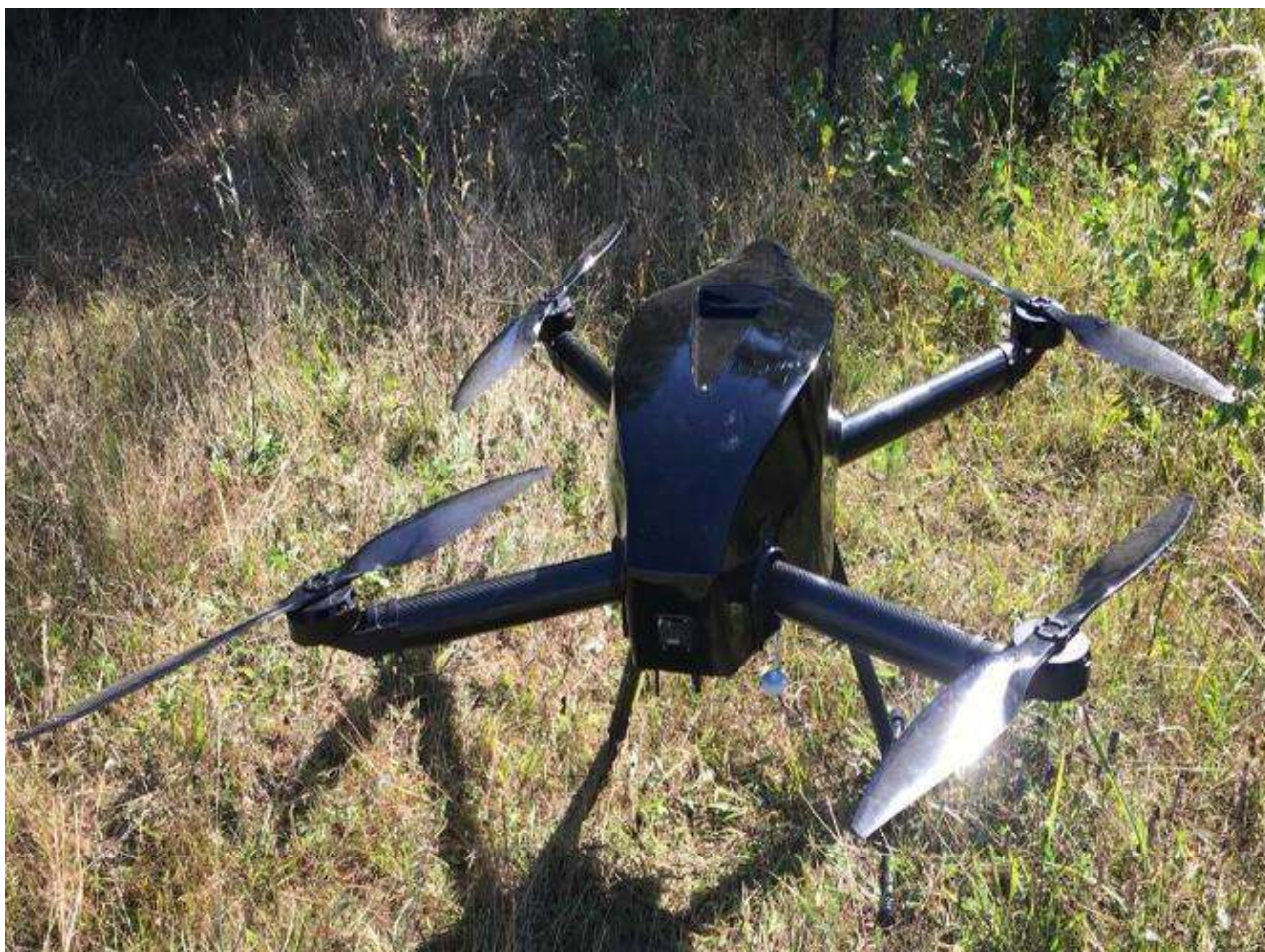
Рис. 210 БПЛА “Нелк – В4-ДВС” типу квадрокоптер з гібридним живленням
