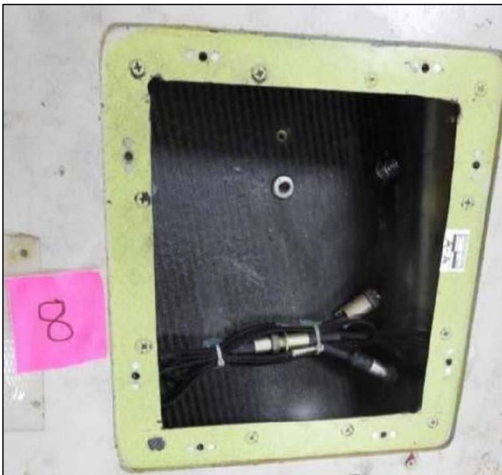
Рис. 23 Роз'єми сервоприводів (Connectors for aileron servos)
