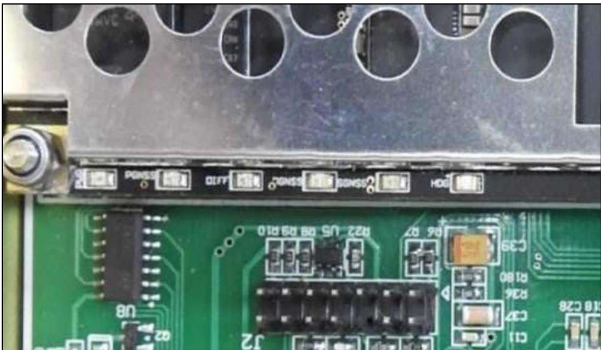
Рис. 29 Індикатори увімкнення режимів «PGNSS, DGNSS, SGNSS, HDG»
