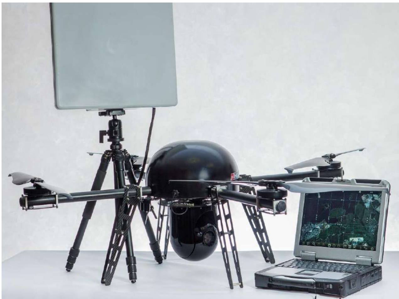
Рис. 209 БпЛА “Нелк – В4.М1” типу квадрокоптер
