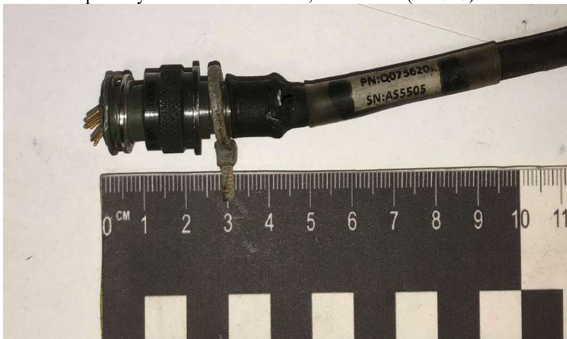
Рис. 47 дріт сервомотору з маркуванням P/N: Q075620 S/N: AS5505
