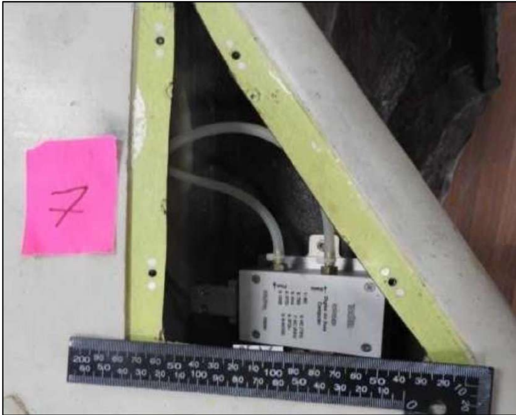
Рис. 22 Блок вимірювання інерції Interia Measurement Unit (IMU)
