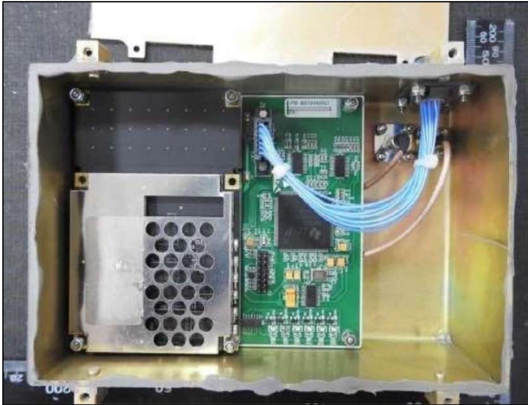
Рис. 28 Вміст Блоку “Automatic take off and landing” (ATOL)
