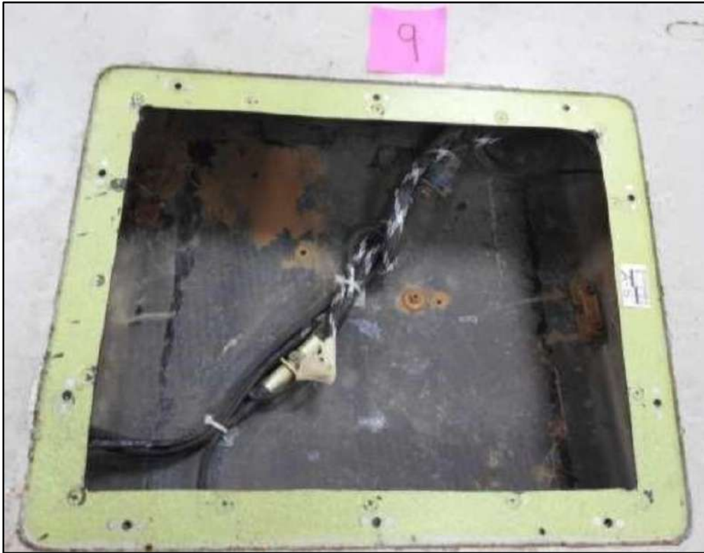
Рис. 24 панель № 9 містить дротові з'єднувачі
