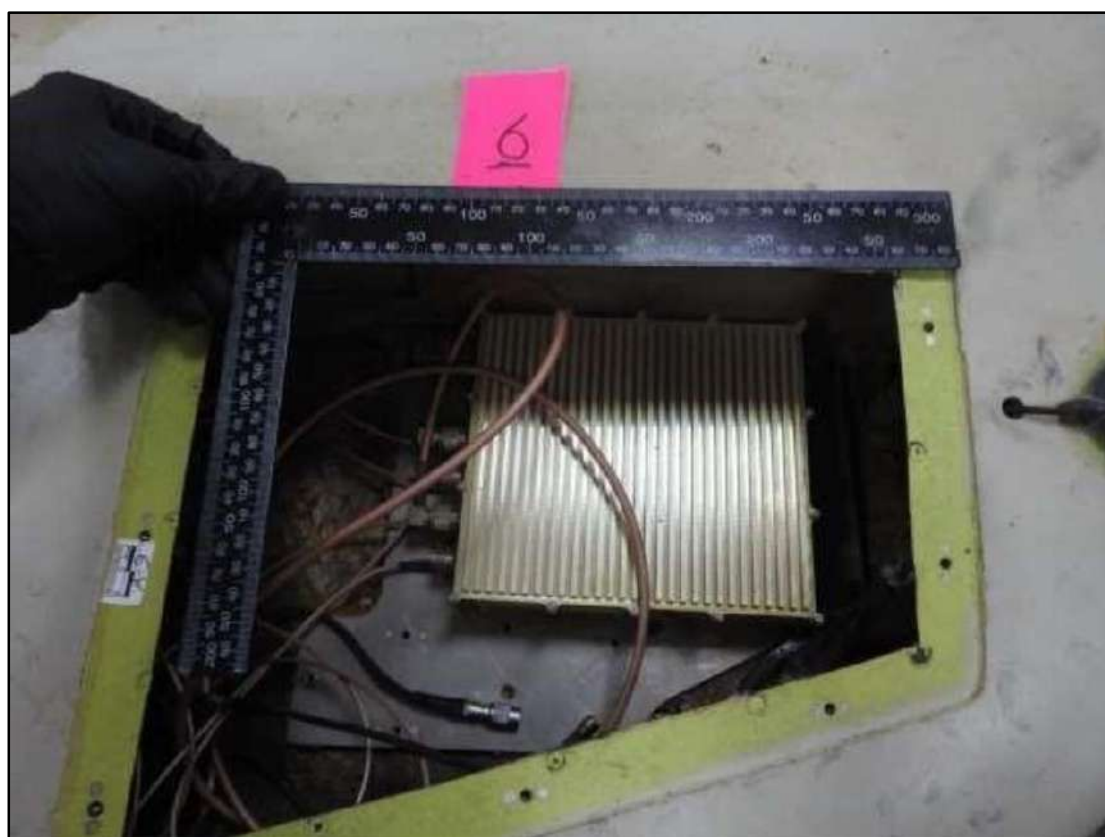
Рис. 18 Панель № 6 – Трансивер системи навігації (GNSS Transceiver) БПЛА “Shahed-131” (Герань-1)
