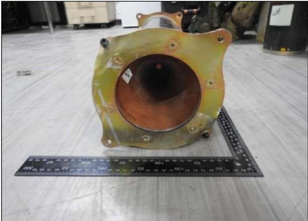
Рис. 6 боєголовка з мідним корпусом для формуючого заряду
