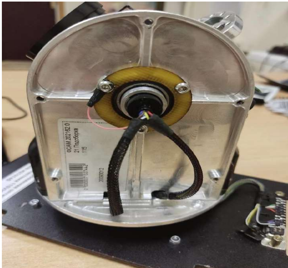
Рис. 135 Зовнішній вигляд місця кріплення двигуна (вигляд праворуч)
