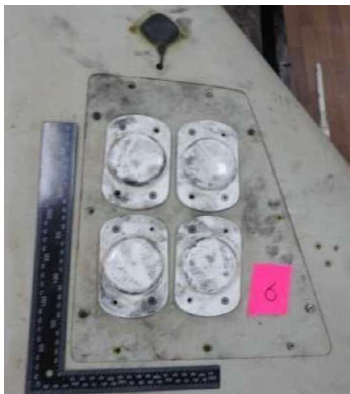
Рис. 17 Панель № 6 – Кришка трансивера системи навігації (GNSS rucks) БПЛА “Shahed-131” (Герань-1)
