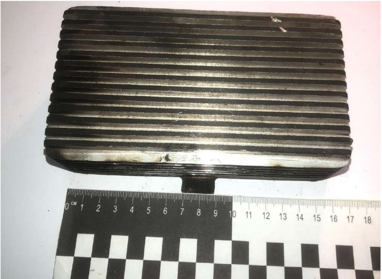
Рис. 36 Корпус Блоку імпульсного модулю, верхня частина
