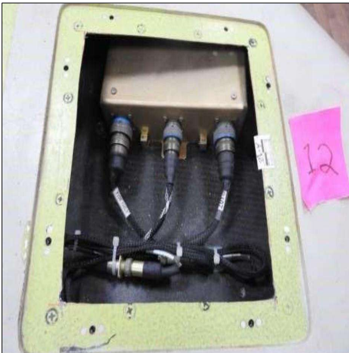
Рис. 30 Блок керування двигуном (ECU)
