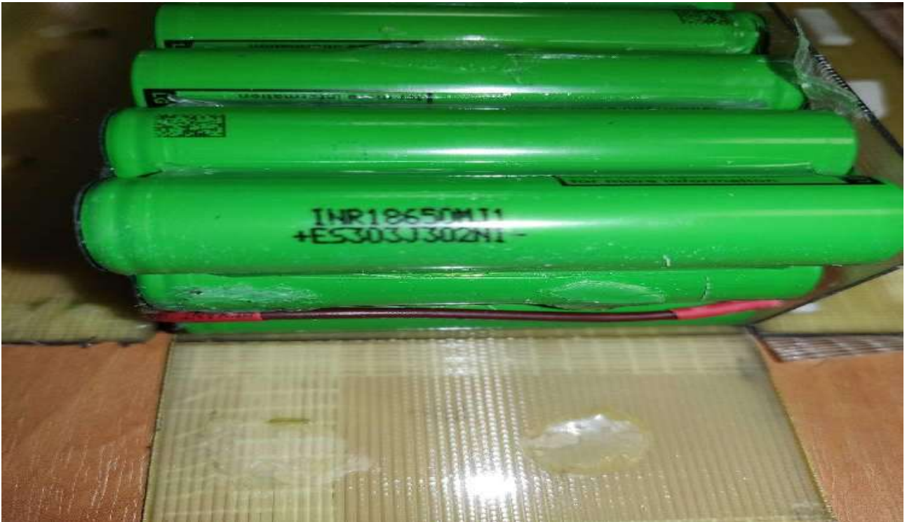
Рисунок 130 Акумуляторні елементи LG INR18650MJ1
