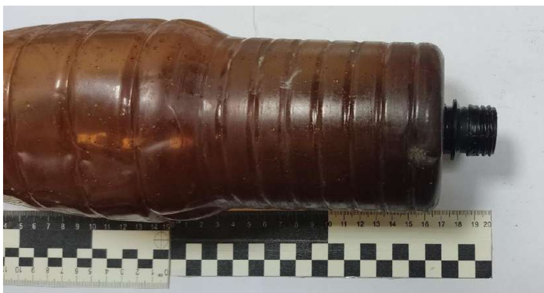
Рис. 77 Паливний бак. Вид з боку горловини
