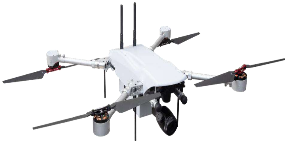
Рис. 206 БпЛА “Zala 421-24” типу квадрокоптер
