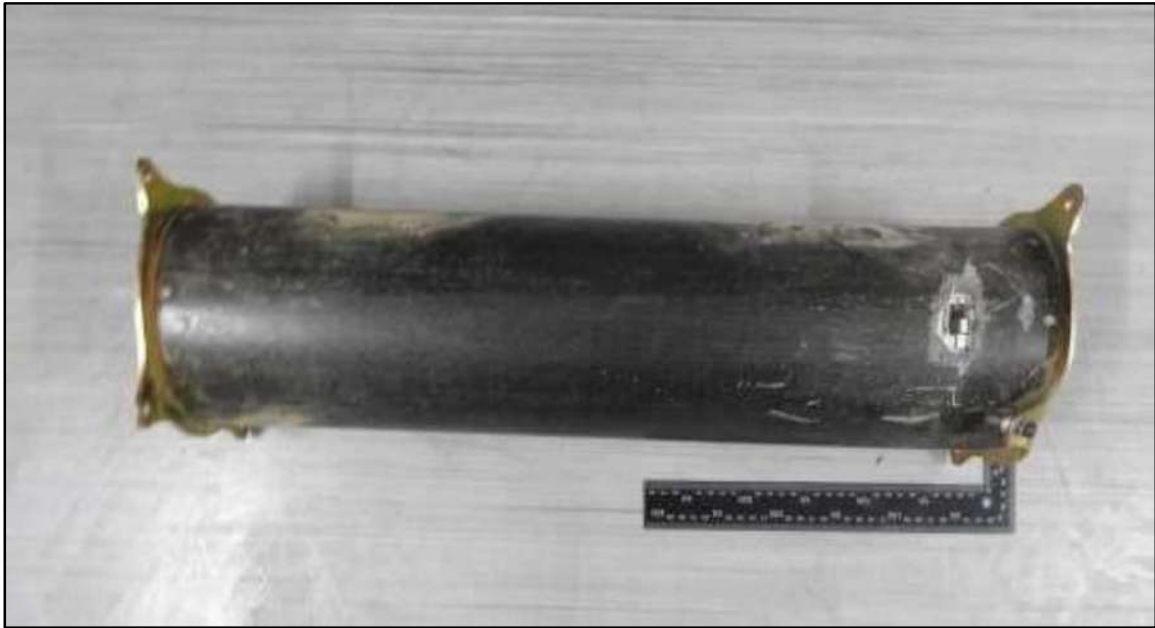
Рис. 5 Боєголовка із запобіжником БПЛА "Shahed-131" (Герань-1)
