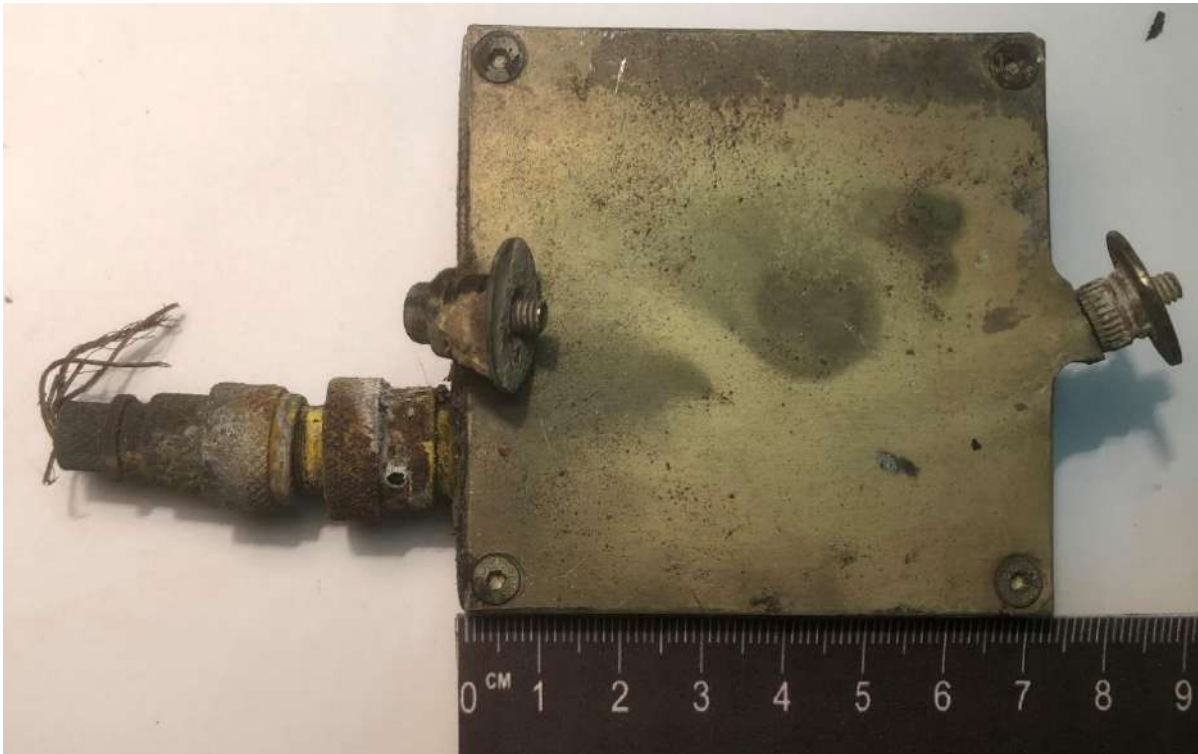
Рис. 43 Блок невідомого призначення - корпус розмірами 7x7x2.7 см з кришкою
