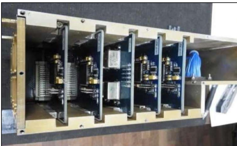
Рис. 14 Вміст Блоку керування польотом Flight Control Unit БПЛА "Shahed-131" (Герань-1)
