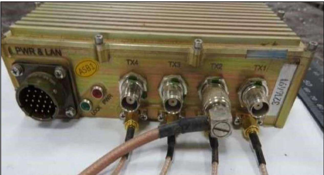
Рис. 20 Трансивер системи навігації (IRN-05 GNSS Transceiver)
