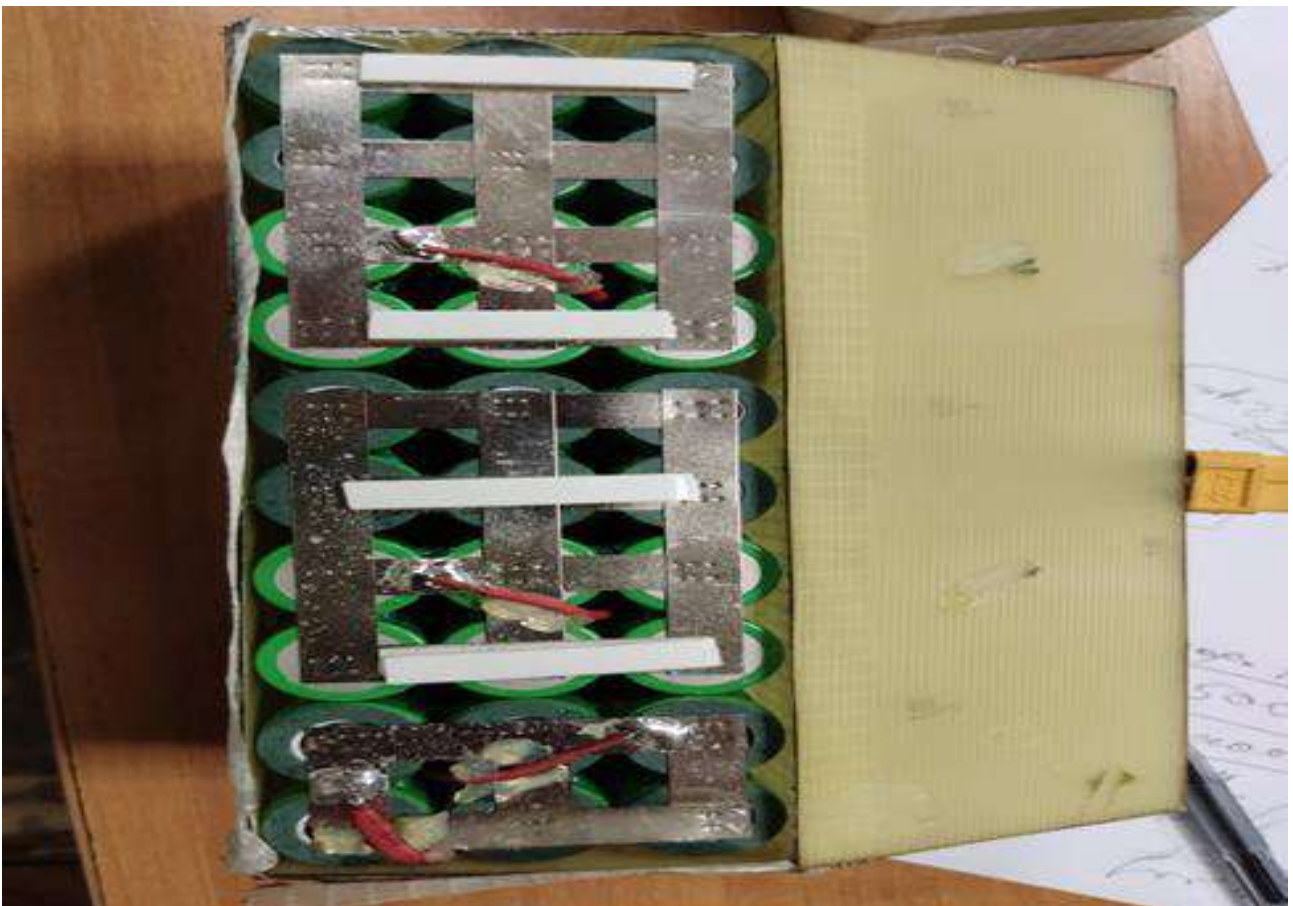
Рисунок 131 Блоки акумуляторних елементів LG INR18650MJ1
